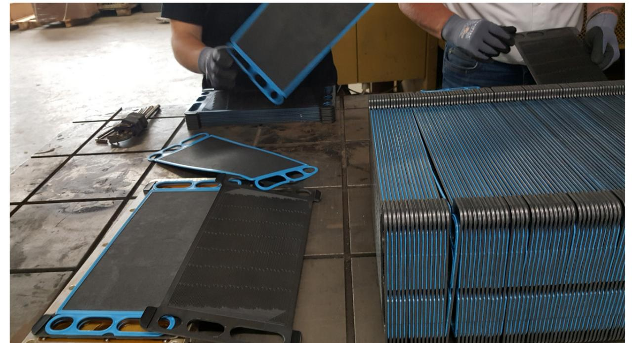
Der Verbund eines Brennstoffzellen-Stacks wird in die einzelnen Brennstoffzellen aufgetrennt. © Fraunhofer IWKS
