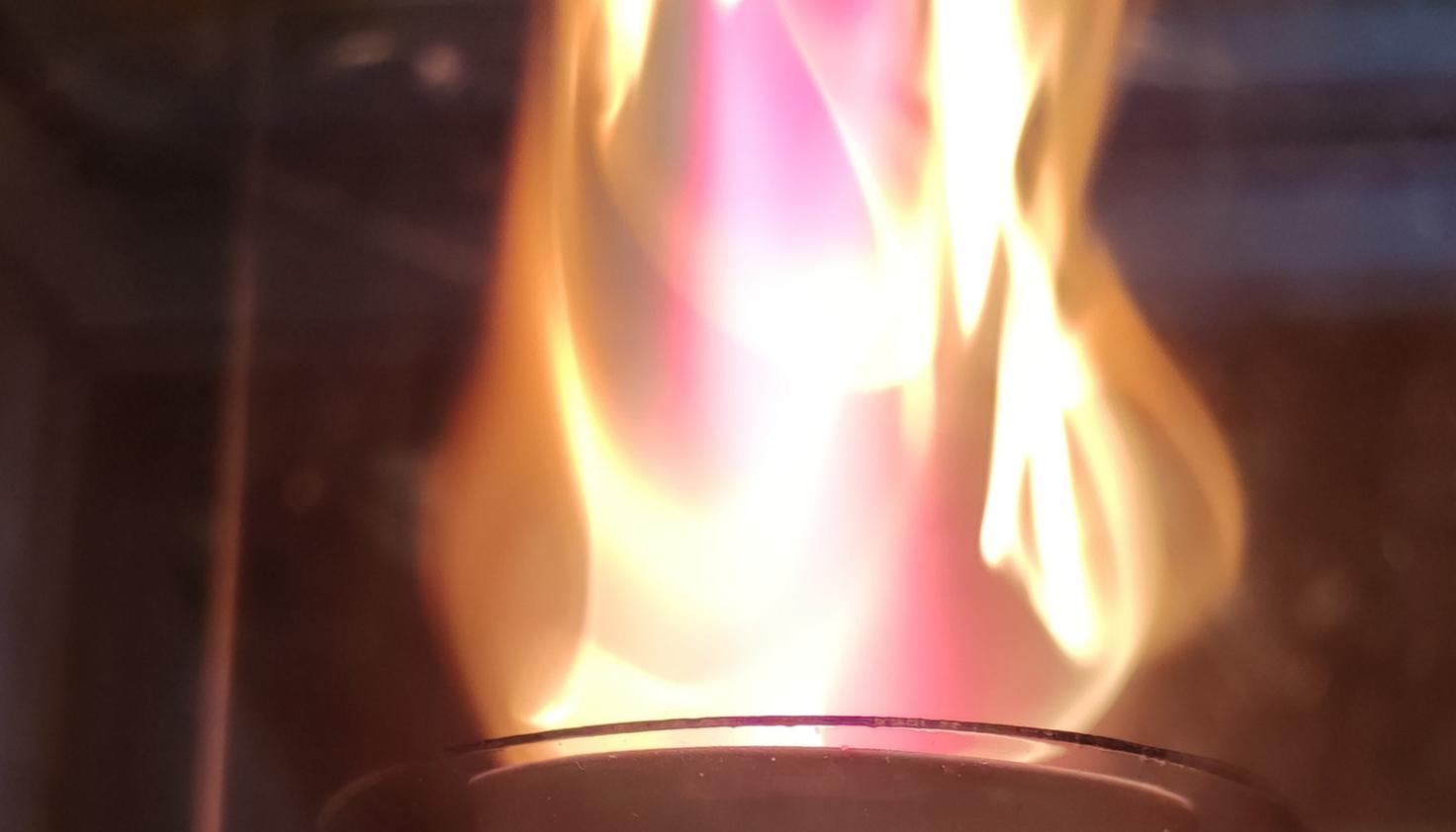
Plasma chemischer Prozess (Plasmalyse) zur Herstellung von Wasserstoff (gasförmig) und Kohlenstoff (fest) durch die Verwertung von kohlenwasserstoffhaltiger Abfallströme. © Fraunhofer IWKS
