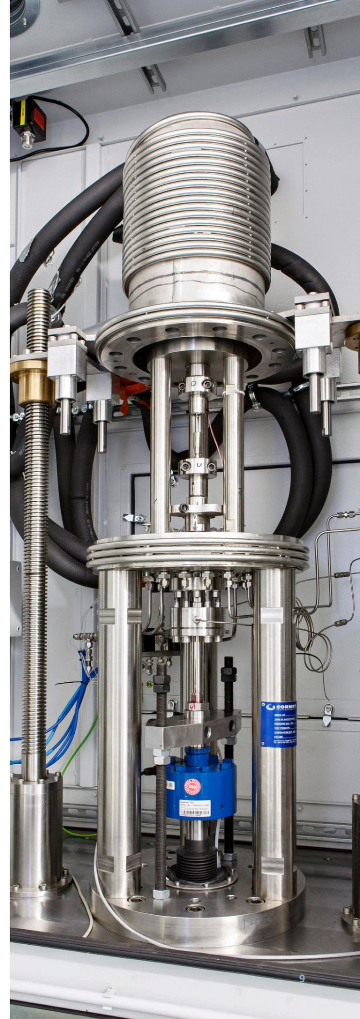
Versuchseinrichtung zur Durchführung von Ermüdungsversuchen unter Druckatmosphäre. © Fraunhofer LBF
